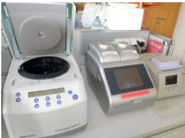
Links Zentrifuge, Thermocycler und Mixblock, rechts Gelelektrophorese
