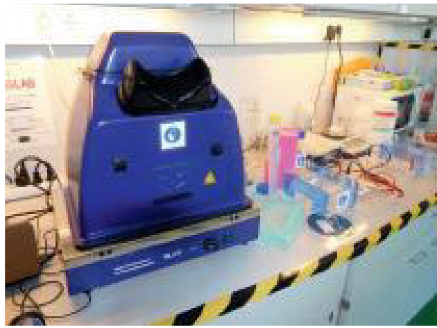
UV-Illuminator links und Gelelektrophoresekammer rechts
